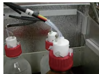
溶剂瓶独立开关阀
