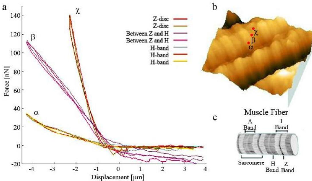
**图 2a** H 区带 (  $\alpha$  ) F/D 曲线 , Z 区带和 H 区带的中间结构 (  $\beta$  ) , Z 区带的结构 (  $\chi$  ) 。
