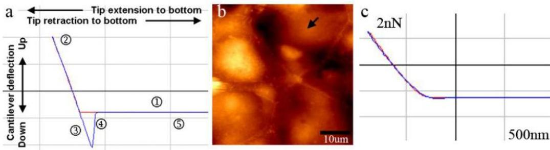
**图 1a** 空气中盖玻片的 AFM F/D 曲线。该 AFM 使用远红外发光二极管 ( SLD )，探针悬臂弹性系数为 60 N/M。红线显示针尖朝向样品移动 ( 1、2 )，蓝线显示针尖远离样品移动 ( 3、4、5 )。蓝线显示探针下降时的弯曲，可以表征针尖与样品间的吸引力 ( 3、4 )。
