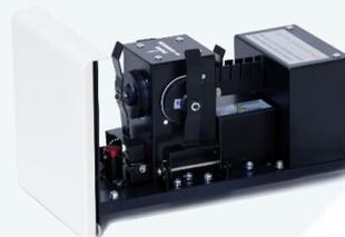
对于不透明样品，如粉末等材料，无法采用直射光系统测试并进一步了解其性能，需要借助积分球测试其漫反射光。漫反射光是与样品内部分子作用以后的光，携带有丰富的样品电子结构和组织信息。
