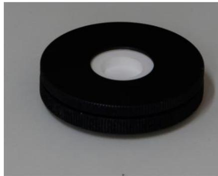
先用标准白板进行基线测试（R%模式），然后对样品进行漫反射测试，得到样品的紫外可见漫反射光谱。
