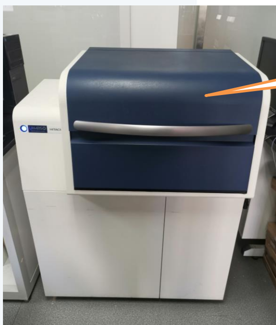
图 2、UH4150 配置 20°-60°连续变角绝对反射附件
