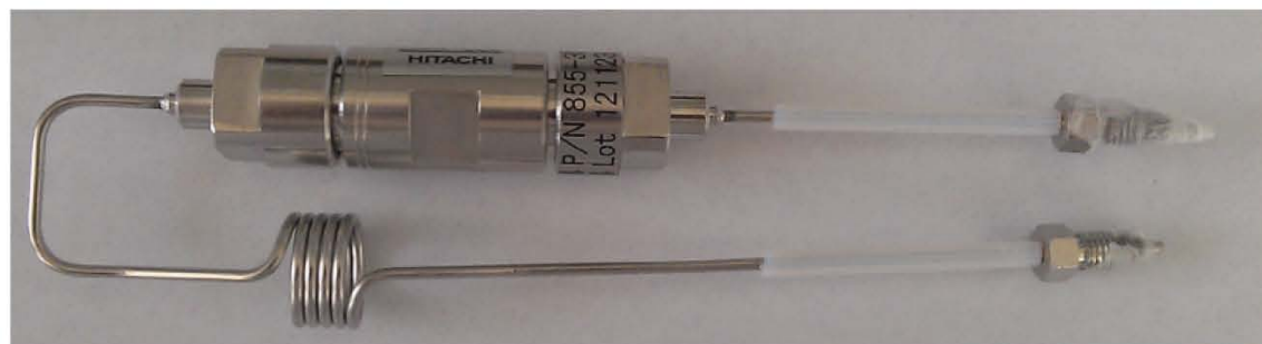
（内置惰性填料的4cm长反应柱）
