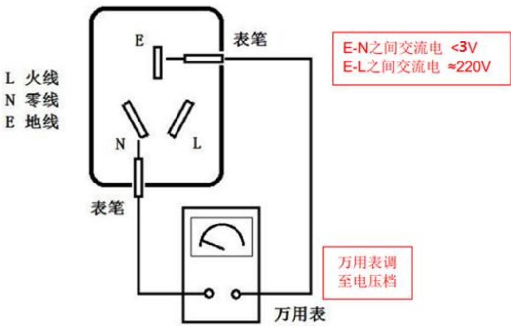
若实测 E-N 间交流电压接近 220V，而 E-L 间电压接近 0V，说明插座零线、火线接反。若实测 E-N 间交流电压高于 3V，说明零地电压过高。可检查如下几个方面：
