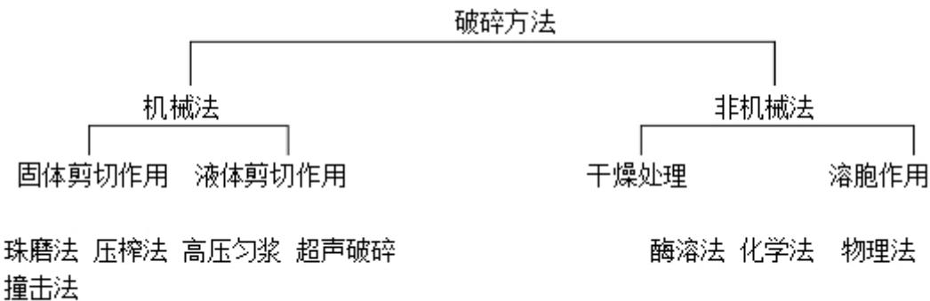
机械方法破碎的处理量大，破碎速度较快，时间短，效率高。其原理是细胞受到挤压，剪切和撞击作用，易被破碎，将细胞内含物全部释放出来，由于机械搅拌产生热量，破碎要采用冷却措施。这里介绍珠磨法和超声波破碎法。
