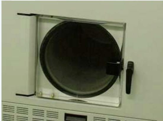
光面冷阱是目前可以获得的造价最低的冷阱类型。通常制冷盘管缠绕在冷阱圆筒的外部，冷阱圆筒内壁被冷却并作为冷凝表面。这种结构宣称的好处是冷凝的过程中，水（或其它溶解试剂）可形成空心圆柱体，在冻干结束后可整个移出冷阱。而在实际使用过程中，这个操作并不容易。相反，用户需要理解的是，光面冷阱具有以下几个缺点：
