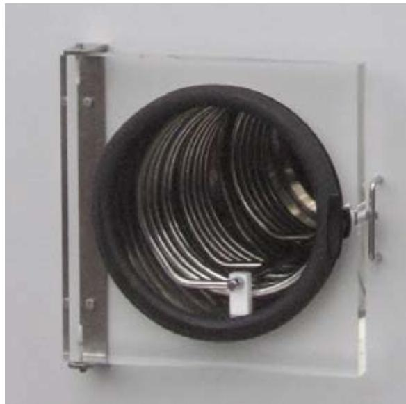
盘管式冷阱是造价相对昂贵的设计。制冷剂直接扩展到盘管上，盘管可直接接触水蒸气。这种设计使得冷阱具有最低的温度，使水蒸气及时冷凝。除此之外，冷凝的水直接凝结在暴露的盘管上，随着冻干的进行，冷凝面积越来越大，使得冷凝的效率逐渐提高。盘管式冷阱设计的唯一缺点是化霜的周期会有轻微的延长，然而，大部分冻干机化霜都需要过夜，因为这种设计带来的负面影响也并不明显。
