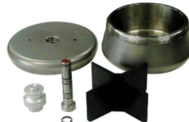
日立区带转头加样和卸载转速依照样品或梯度液的不同，可以在2,000rpm—3,000rpm之间调节，在加样完成后可以从加样转速直接加速到32,000rpm（真空度同步提高）。节省了等真空的时间。
