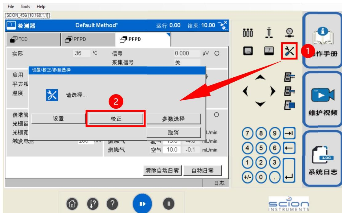
第三步，点击上图中的“校正”图标，将出现下图界面，接着再点击“更换/检查注射器”图标，等待自动进样塔开始转动完成。
