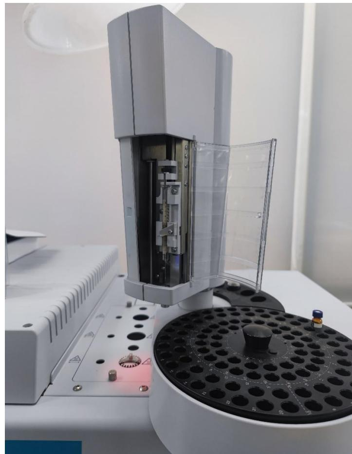
最后，清洗更换完成后，安装好进样针，点击下图中的“确认”图标，自动进样塔将自动转回至默认位置。
