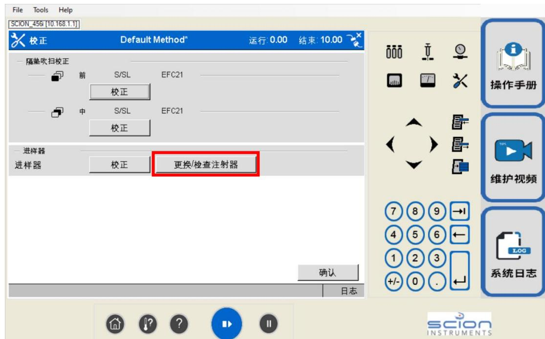
自动进样塔转动，如下图所示，当转动到固定位置后，可以打开自动进样塔的门，进行进样针的更换和清洗。
