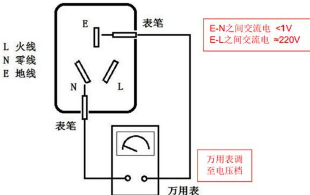
若实测 E-N 间交流电压接近 220V，而 E-L 间电压接近 0V，说明插座零线、火线接反。若实测 E-N 间交流电压高于 1V，说明零地电压过高。可检查如下几个方面：
