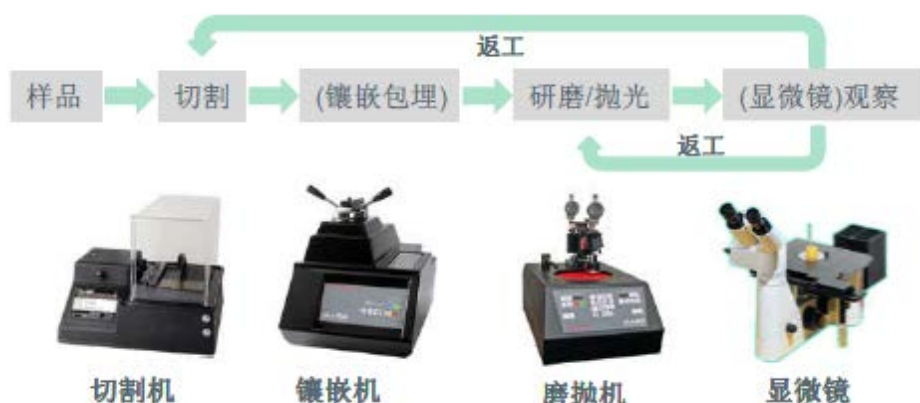
图 1. 传统电镜样品的制备流程
