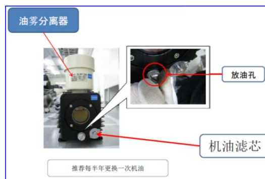
图三：机械泵及内外烘烤装置
