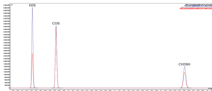
Figure 1 显示的是2个色谱图的叠加。蓝色曲线为使用Mini Gas Splitter的谱图, 红色曲线为使用标准进样口的谱图。记录三次蓝色曲线以评估性能的一致性。它表现出1%或更好的可重复性。观察两种进样口对等摩尔硫的响应, 可以看出使用MiniGasSplitter后表现出最小或无吸附的特性
