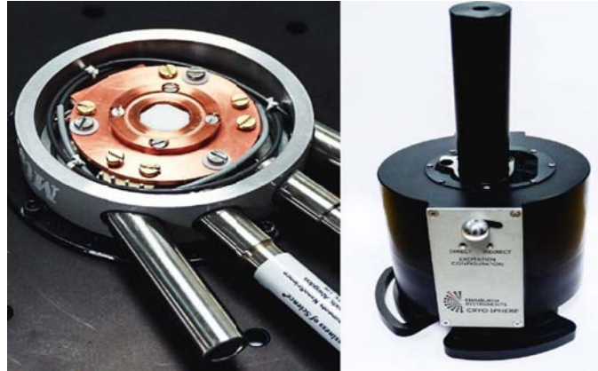
Figure 2：变温样品支架（左）及爱丁堡变温积分球附件（右）
