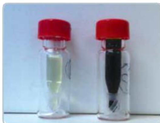
图 1 空白提取物（左），污泥提取物（右）
