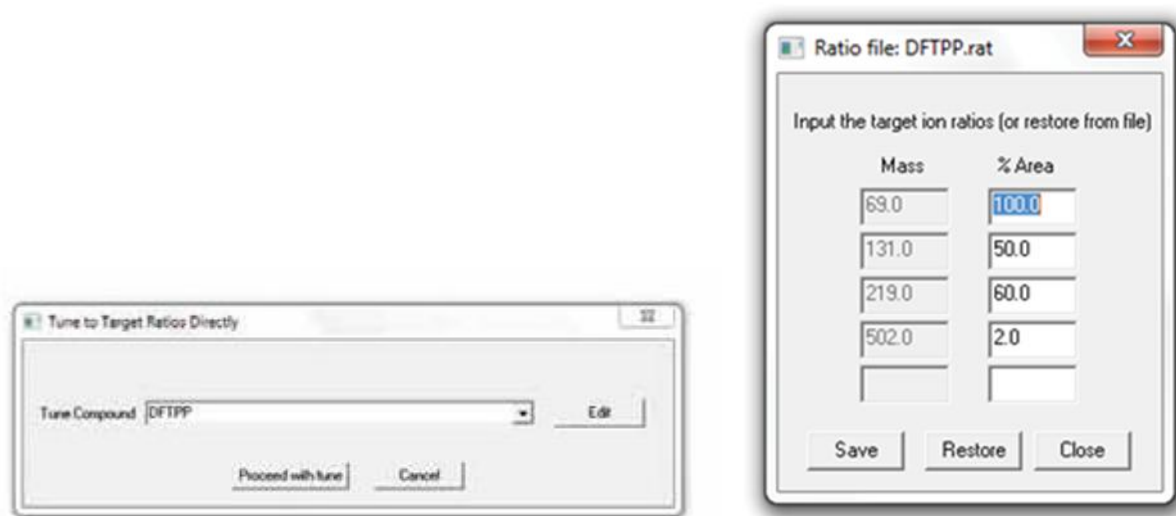
图 4 DFTPP 的根据目标物调谐方法
