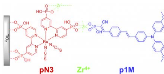
图 2：佛罗里达州立大学 Hanson 教授研究的多层自组装 DSSCs 结构。
