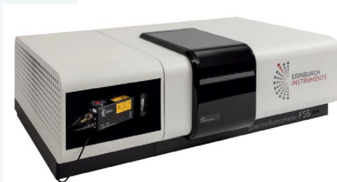
图 2. 耦合用于稳态及电致发光测试的光源和电源，功率计，函数发生器的 FS5 光谱仪
