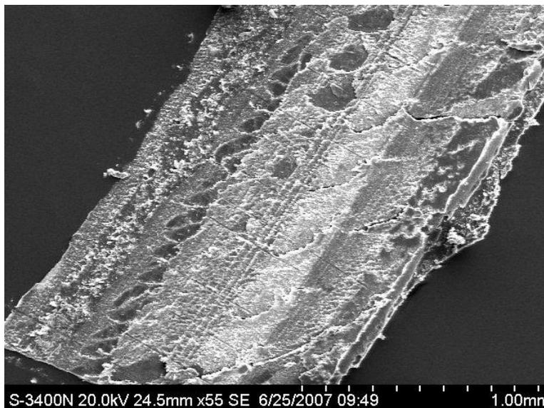
**盗窃案件分析**——盗窃犯利用钳、剪等工具剪切铜、铝、铁丝等物体，会在钳、剪的刃口部位留下附着物，利用扫描电镜/能谱仪检验其元素成份，与被剪物进行同一认定检验，以判定被检物是否是作案工具。
