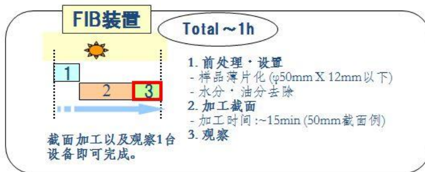
图5 MI4050 型 FIB 系统工作流程图
